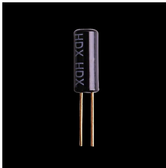
Tilt-sensor — cylindrisk kapsel med en lös metallkula inuti. Lutad → kulan rullar mot två stift → kortslutning.
