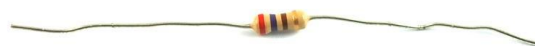
Resistorn läses från den ände där färgbanden ligger tätast. 220 \Omega = röd-röd-brun-guld (4-band) eller röd-röd-svart-svart-brun (5-band). Bilaga C har full tabell.
