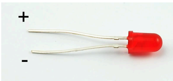
LED:ens polaritet — långt ben (anod) till plus, kort ben med platt kant (katod) till GND.
