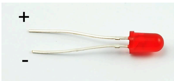
Lysdiod med markerad anod (+, långt ben) och katod (-, kort ben med platt kant).
