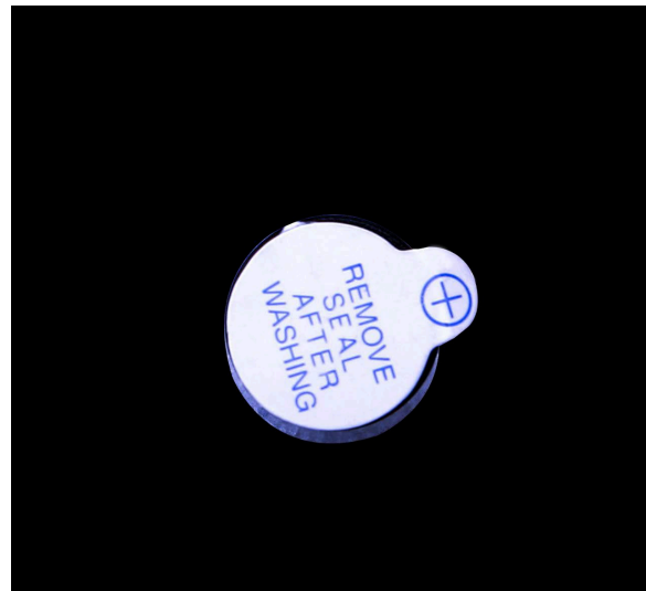
Active buzzer — svart cylinder med klisterlapp och plusmarkering på ovansidan. Lappen stannar kvar .
