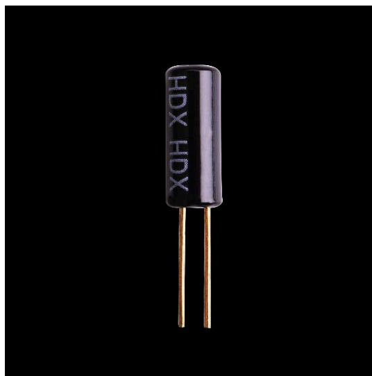
Tilt ball switch — cylindrisk kapsel med lös metallkula inuti.
